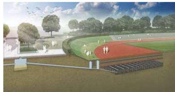
**Abbildung 4:** Systemskizze der Überstau- und Notüberlaufmöglichkeit des Hein-Klink-Stadions in Hamburg – ist das unterirdische Rigolensystem komplett ausgelastet, kann noch das tiefergelegte Stadion selbst eingestaut werden, Quelle: © Naumann Landschaft.
