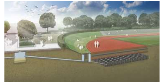
Systemskizze der Überstau- und Notüberlaufmöglichkeit des Hein-Klink-Stadions in Hamburg
